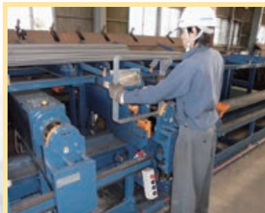
機械化された加工場で鉄筋を加工する。
